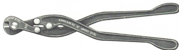
18" BOLTEKUTTER av smidd stål med herdede kjeffer. Boltekutteren er beregnet for klipping av inntil 6 mm uherdet tråd. Boltekutteren må ikke brukes til klipping av herdede deler, f. eks. tverrlenker på bilkjettinger o.s.v.
